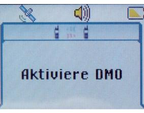
Das Funkgerät wechselt in die Betriebsart DMO - Direct Mode.
