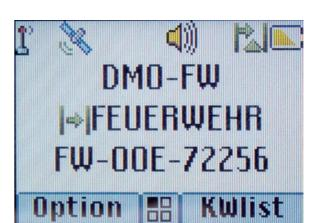
Das Funkgerät befindet sich in der DMO Sprechgruppe FEUERWEHR.
