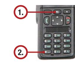
Tastensperre lösen. Die Funktion der automatischen Tastensperre kann dauerhaft über das Menü deaktivert werden
